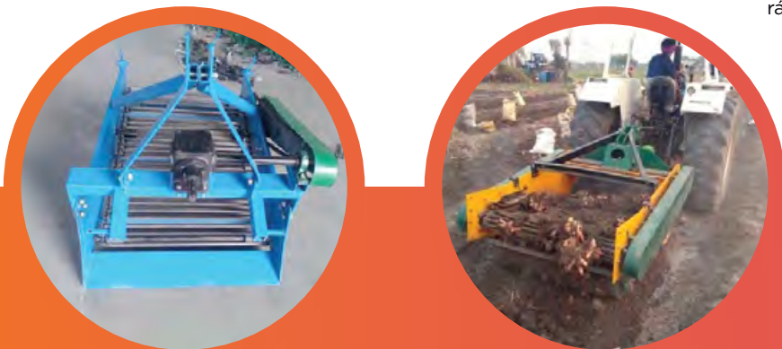
Figura. 1. Cosechadora de cúrcuma utilizadas en la India.
